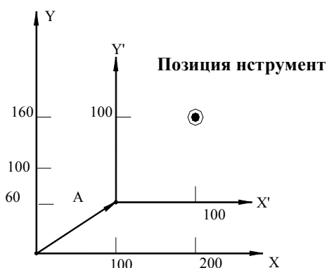
Рис. 11 Установка локальной системы координат
